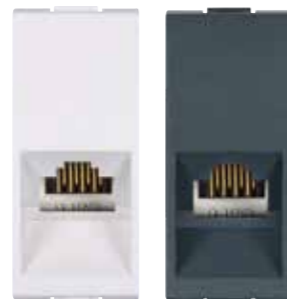
664S.x Priključnica komunikacijska, Keystone RJ45 Cat 5e FTP 1M Data socket Keystone RJ45 Cat 5e FTP 1M • Usaglašeno sa IEC 60603-7; • Montaža provodnika bez upotrebe alata (Toolless); • Spajanje prema TIA/EIA-568A ili 568B standardu za raspored parica; • Ugradnja u noseću pribornicu utiskivanjem
